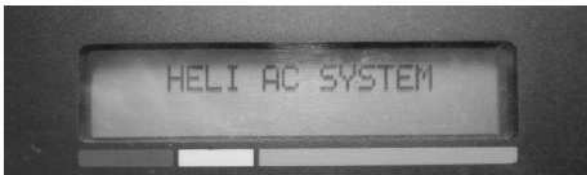
Рис. 4-24. Дисплей устройства ZAPI при подаче электропитания (отказов нет)
